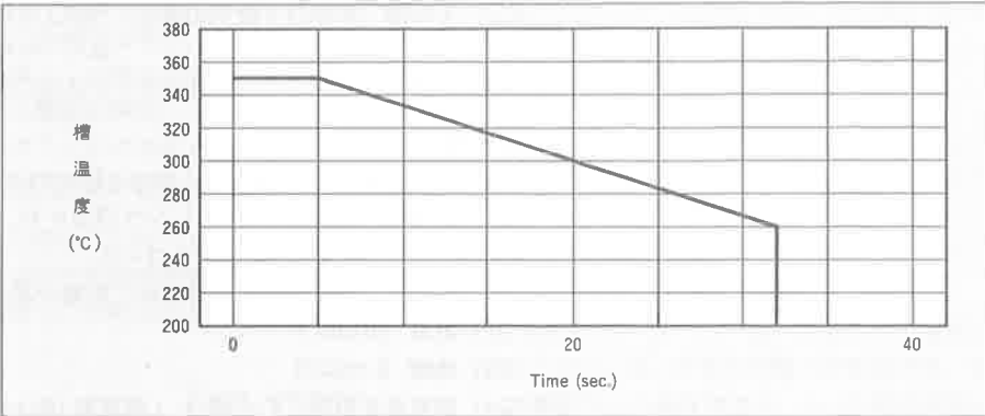
ハンダリフロー条件範囲 (最高到達温度の設定範囲)
