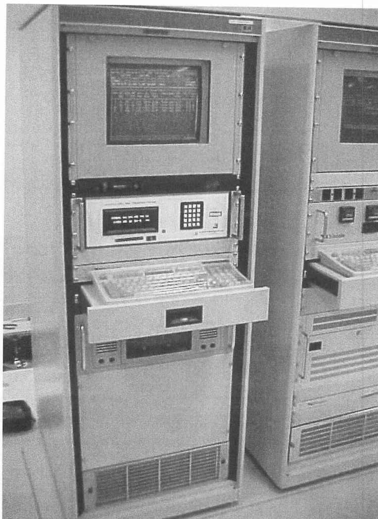
第8図 時刻比較用 GPS/GLONASS 衛星受信システム
