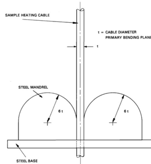
Figure 3—Cold bend test apparatus
