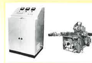
NC 装置（数値制御装置） Numerical Control for Machine Tool
