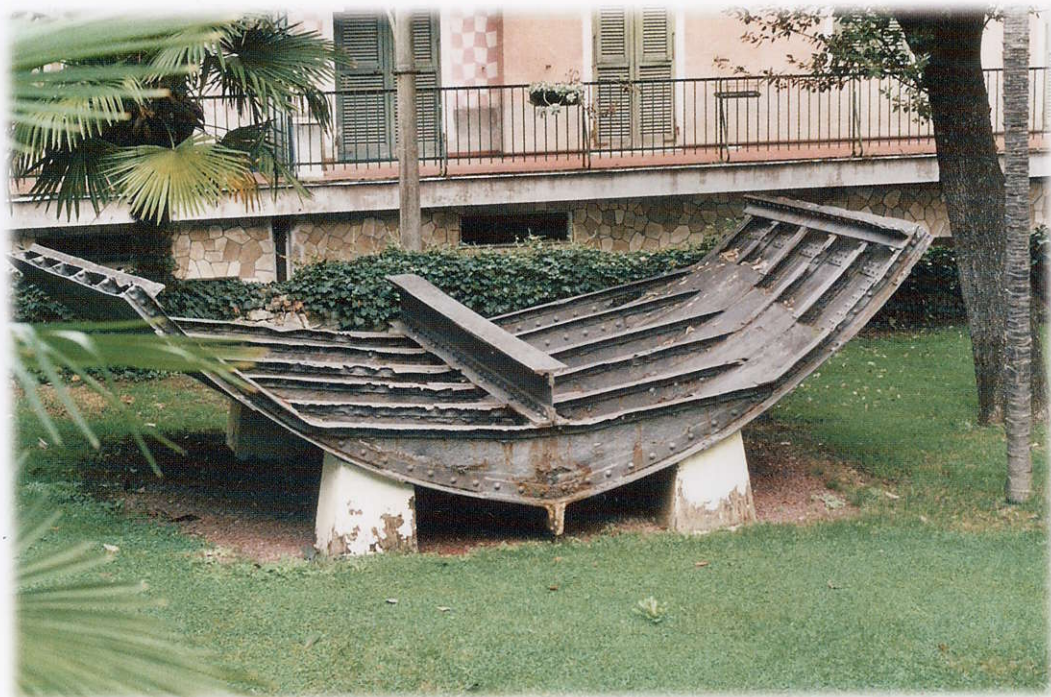
Santa Margherita Ligure (Villa Durazzo): Sezione della chiglia composta da cinque ordinate. (foto Ugo Ivani)
